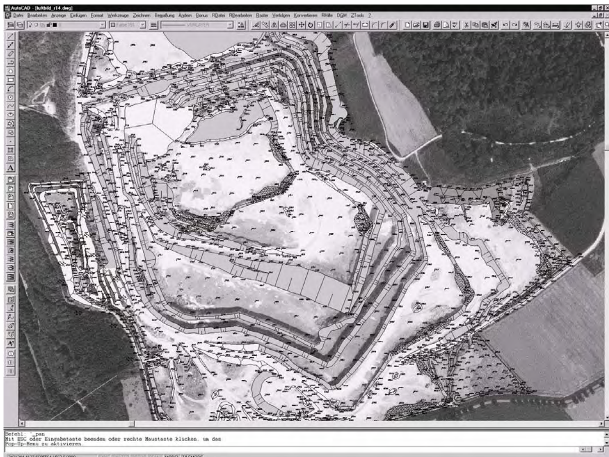
Abb. 2: Aerophotogrammetrische Auswertung eines Gewinnungsrisses mit Luftbildhinterlegung.
